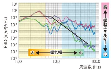
— エアサス車 — プラパール® ピタパッドエアサス — 板バネ車 — プラパール® ピタパッド板バネ
