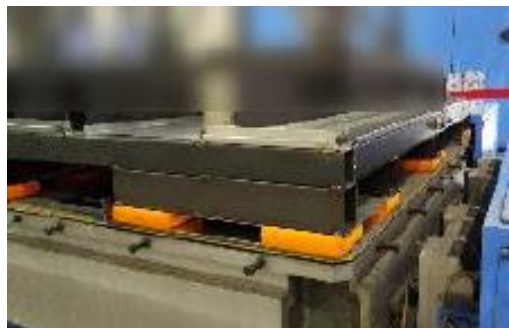
スチールピタパレットの振動試験状況
