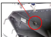
振動制御用センサ（振動台裏面）
